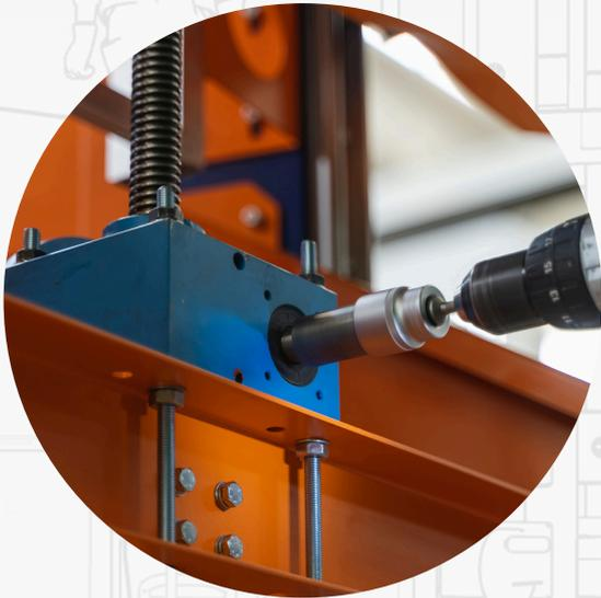
**Regolazione altezza di sbarco con avvitatore elettrico**
